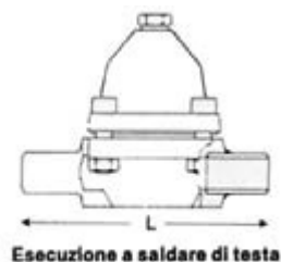
Esecuzione a saldare di testa
